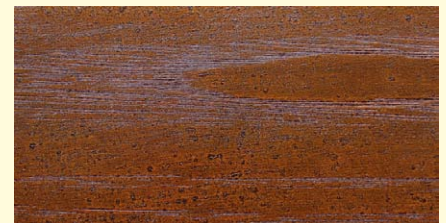
(2)塗装した栗材 (ダークブラウンを2回塗りっぱなしにて塗装)
